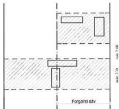
5 évnél régebbi burkolat bontásnál - út/járda/Kerékpárút
