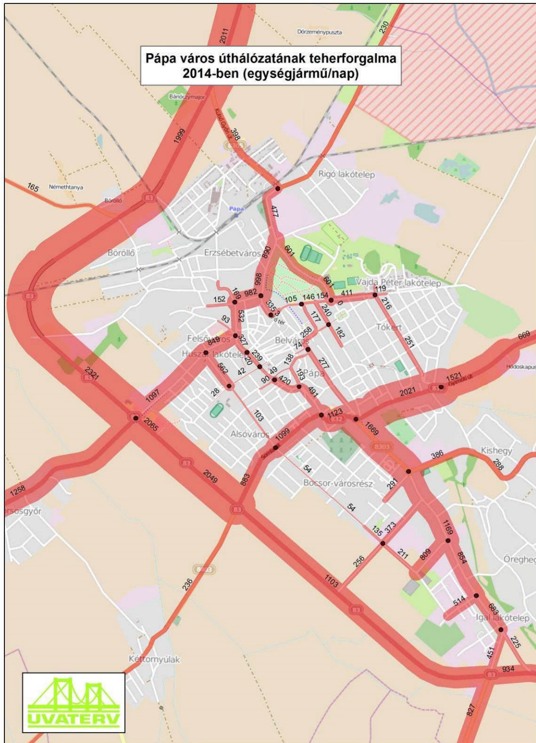
4-27. ábra: Pápa város közúti forgalomterhelése, nehézgépjármű forgalom (Ejm/nap/keresztmetszet)
